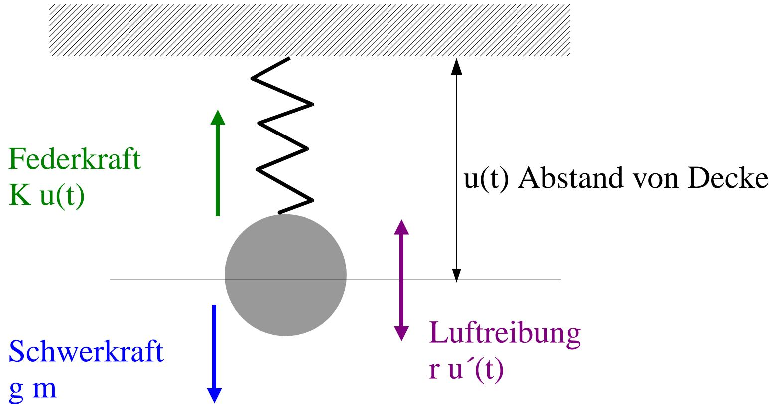
$$\text{Masse} \times \text{Beschleunigung} = \text{Gesamtkraft}$$
