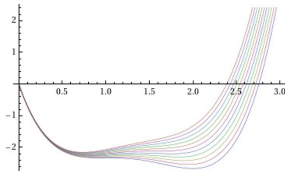
wobei das Index  $k$  sich von den unteren nach den oberen Kurven erhöht. Der tiefste Punkt nach rechts entspricht einem stabilen Gleichgewicht  $x^* > 11/7$  in dem gilt  $r'(x^*) < 0$ . Der tiefste Punkt nach links entspricht einem stabilen Gleichgewicht  $x^* < 1$  in dem gilt  $r'(x^*) < 0$ . Der höchste Punkt in der Mitte entspricht einem instabilen Gleichgewicht  $x^* \in (1, 11/7)$  in dem gilt  $r'(x^*) > 0$ .
