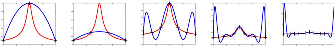
Abbildung 1: Resultate für  $N=2, 3, 6, 10, 14$ : Rote Linie zeigt Funktion  $f$ , die Blaue die Interpolation, welche starke Oszillationen aufweist.
