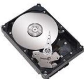
ad 4. Die von uns gewählten Festplatten mussten hauptsächlich eine akzeptable Zugriffszeit haben. Diese ist mit 8,5 ms bei 7200 U/min weitgehend erfüllt. Aufgrund der SATA Technologie ist es möglich, die zwei gekauften HDDs als Raid anzulegen und somit eine erhöhte Datensicherheit zu gewährleisten. Die Größe ist mit 160GB ausreichend ausgelegt.
