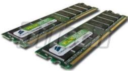
ad 2. Wir haben einen DDR2-RAM KIT mit 1 GB von Corsair ausgewählt, aufgrund der DualChannel Fähigkeit des Motherboards (siehe 3.), um eine Erhöhung der Bandbreite zu erreichen.
