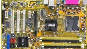
ad 5. Als Netzwerkkarte wird die Onboard Karte des Motherboards (siehe 3.) verwendet, da sie mit 1 Gbit fürs Erste leicht ausreicht.
